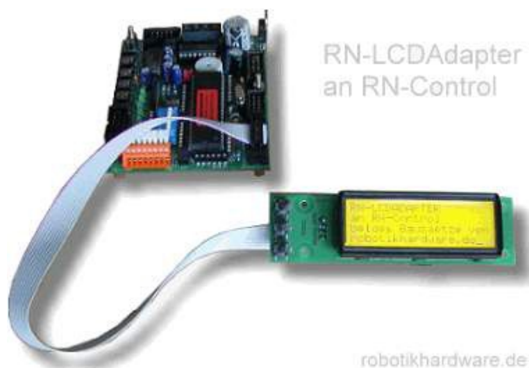
Über RN-LCDADAPTERSTD einfach verschiedene LCD's anschließen
